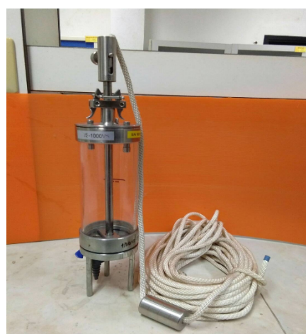
ภาพที่ 15 : ภาพเครื่องเก็บตัวอย่างน้ำแบบแนวนอน และแนวตั้ง
