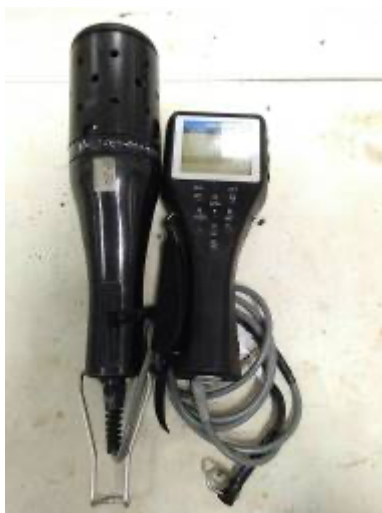
ภาพที่ 14 : ภาพเครื่องมือตรวจวัดคุณภาพน้ำได้หลายค่าเช่น อุณหภูมิ ความเค็ม ออกซิเจนที่ละลายในน้ำ และความเป็นกรดเป็นด่าง (pH)
