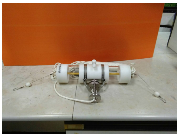
ภาพที่ 15 : ภาพเครื่องเก็บตัวอย่างน้ำแบบแนวนอน และแนวตั้ง
