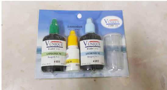
ภาพที่ 16 : ภาพตัวอย่างเครื่องมือตรวจวัดคุณภาพน้ำแบบภาคสนาม
